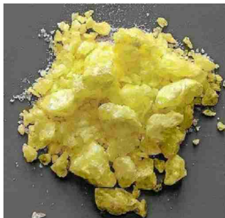
Schwefel (links) ist der erste eingesetzte Rohstoff für die Produktion von Schwefelsäure. Ein weiterer Rohstoff dafür war in Uetikon während Jahrzehnten Pyrit. Die Kristalle weisen eine goldglänzende Fläche auf und werden daher auch Katzungold genannt. Rechts: Düngerwerbung in der Nachkriegszeit.
